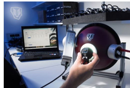
Messung der Lichtleistung
